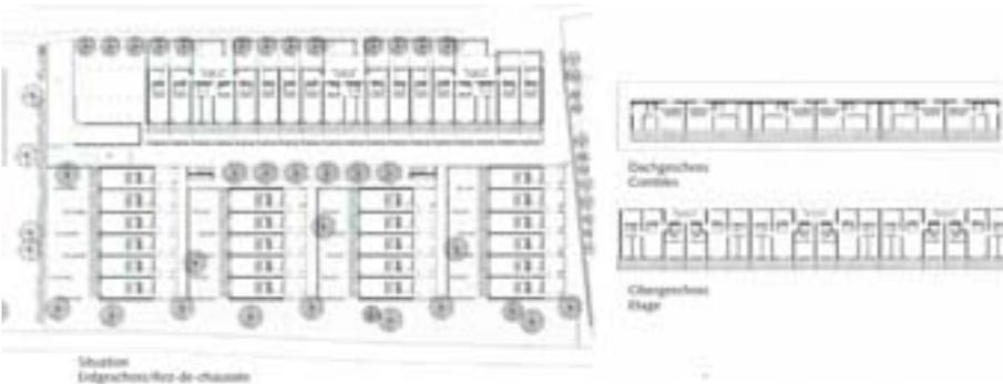
L'objectif étant de construire des logements économiques de qualité supérieure, les architectes conçoivent un système simple, répétitif permettant une préfabrication importante et une mise en oeuvre rapide.
